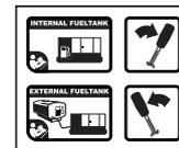
Обозначает трехходовой топливный клапан.
