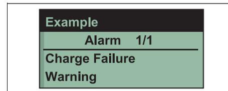
В случае подачи аварийного сигнала на ЖК-дисплее отобразится представление страницы аварийных сигналов и будет выполнен переход по активным предупреждениям и анонсам останова работы.
